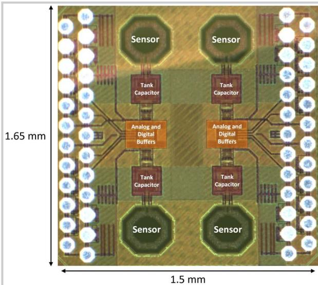
Figure 10.7.7: 2x2 chip sensor array die photo.
